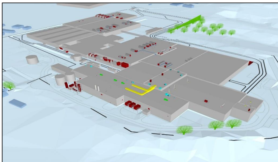
Zajmodell felépítése az IMMI zajtérképező szoftverben (háromdimenziós) Fotó forrása: FONOR Környezetvédelmi és Munkavédelmi Kft.
