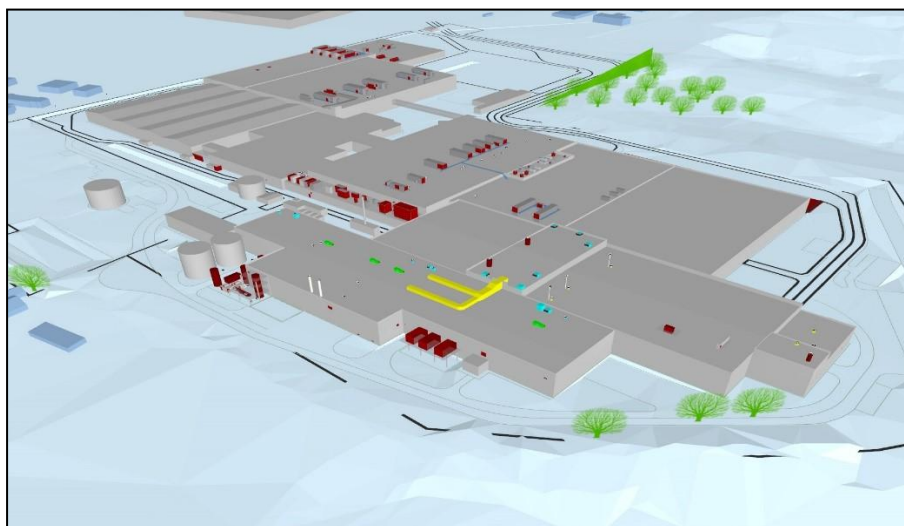
Zajmodell felépítése az IMMI zajtérképező szoftverben (háromdimenziós)
